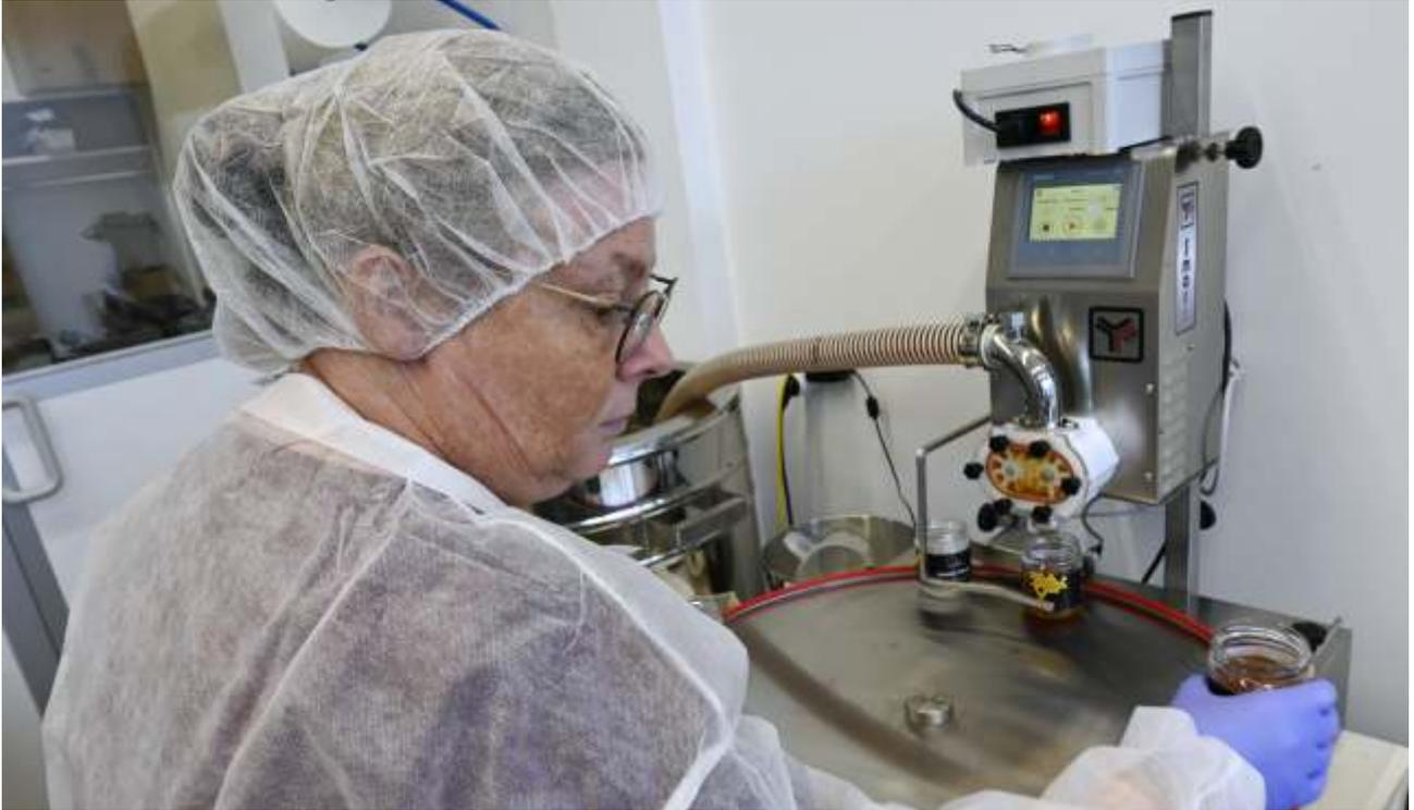
Eine spezielle Reinraumkleidung, die als Einweg- oder Mehrwegbekleidung erhältlich ist, trägt dazu bei, die Partikelkonzentration im Reinraum entsprechend gering zu halten.
